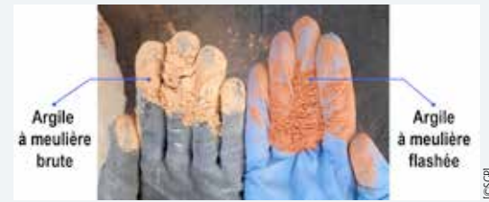
Argile à meulière brute et flash calcinée. L'observation visuelle montre un changement d'aspect (couleur).
