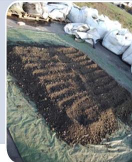
Homogénéisation de chaque échantillon sélectionné
