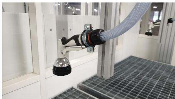
Figure 16 : Système simulant la pluviométrie
