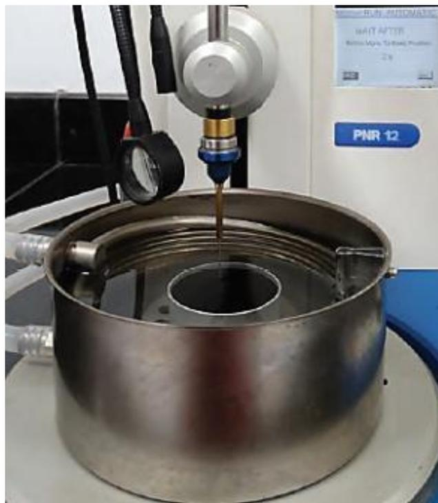
*Figure 6. Essai de pénétrabilité à l'aiguille.*
