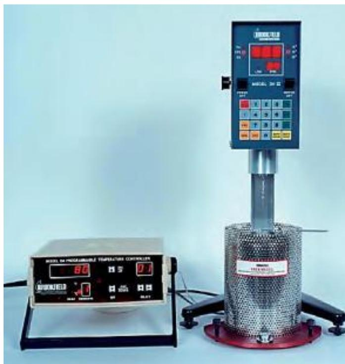
*Figure 10. Viscosimètre rotatif.*
